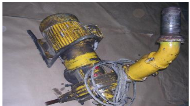
Bomba – Marca: EISELE – Modelo DLP 150-4 11Kw 15PS
