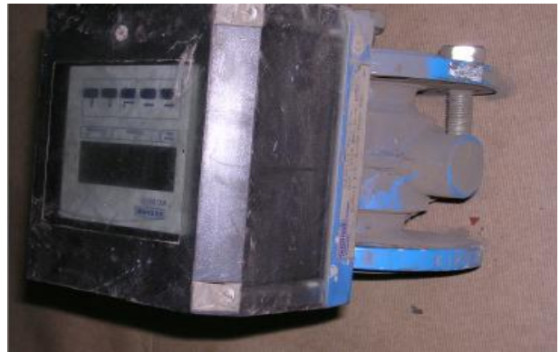
Caudalímetro – Marca: KROHNE AQUAFLUX IFC 010 D 410 KID -6 A Q= 0-20 metros cúbicos P= 1PS
