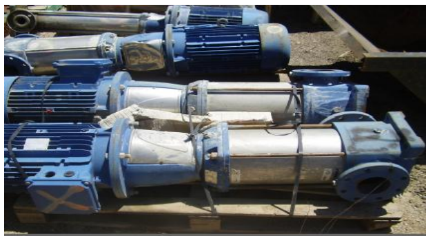
7 BOMBAS LOWARA SUELTAS 18,5 KW – V400 – A32,8 RPM 2945 MOTORES CM 160 B5/3185
